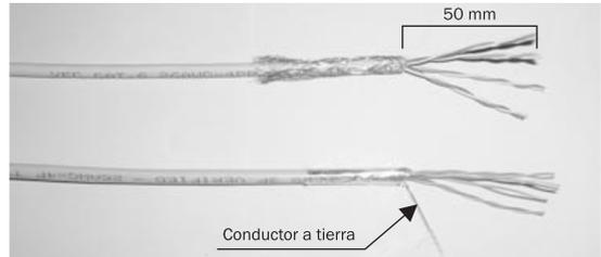
Pele aproximadamente 50 mm del revestimiento del cable, retire hacia atrás el blindaje y separe los cables en grupos de 4 pares cada uno.
