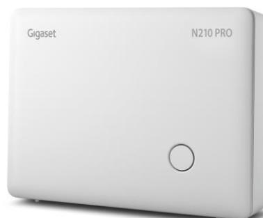
Gigaset N210 PRO es una estación base DECT estándar compatible con todos los terminales profesionales de Gigaset, permitiendo una configuración flexible y personalizada de su sistema telefónico empresarial. Gracias a la tecnología DECT, los terminales profesionales pueden ubicarse de forma separada a la base y moverse libremente alrededor de la misma.
