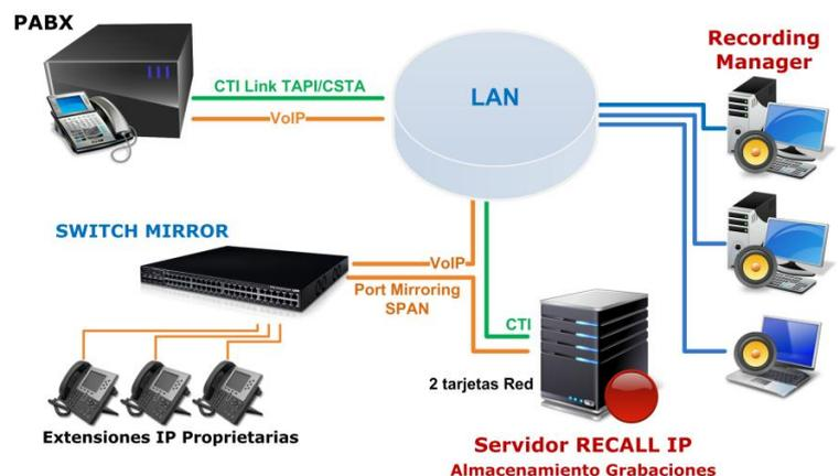
*En modo grabación pasiva un switch Ethernet con SPAN (Port Mirror) monitorea el tráfico de Voz mientras la señalización se obtiene a través del canal CTI.*
